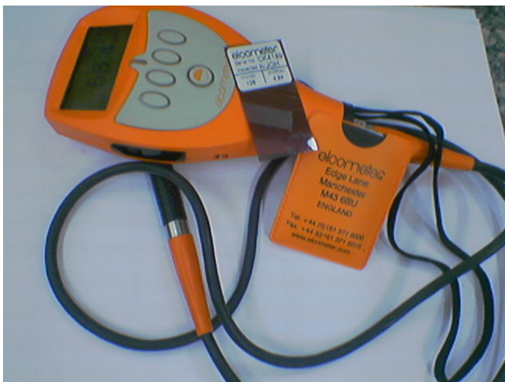
شکل ۴-۱- پراب جریان القایی برای اندازه گیری ضخامت پوشش
