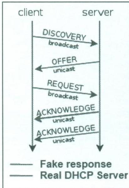
Fig. 4.32.- Ataque DHCP ACK Injection.
