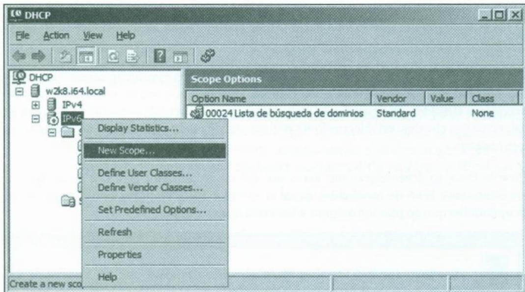
Fig. 5.63.- Configuración de un nuevo ámbito IPv6.
