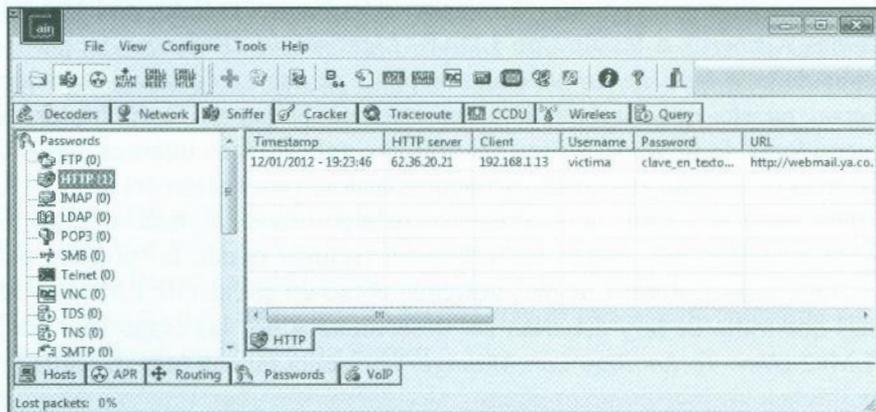
Fig. 4.21.- Obtención de clave en un formulario HTTP.
