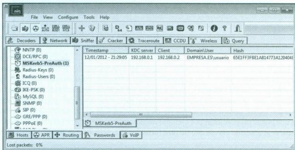
Fig. 4.23.- Obtención del proceso de pre-autenticación *Kerberos*.
