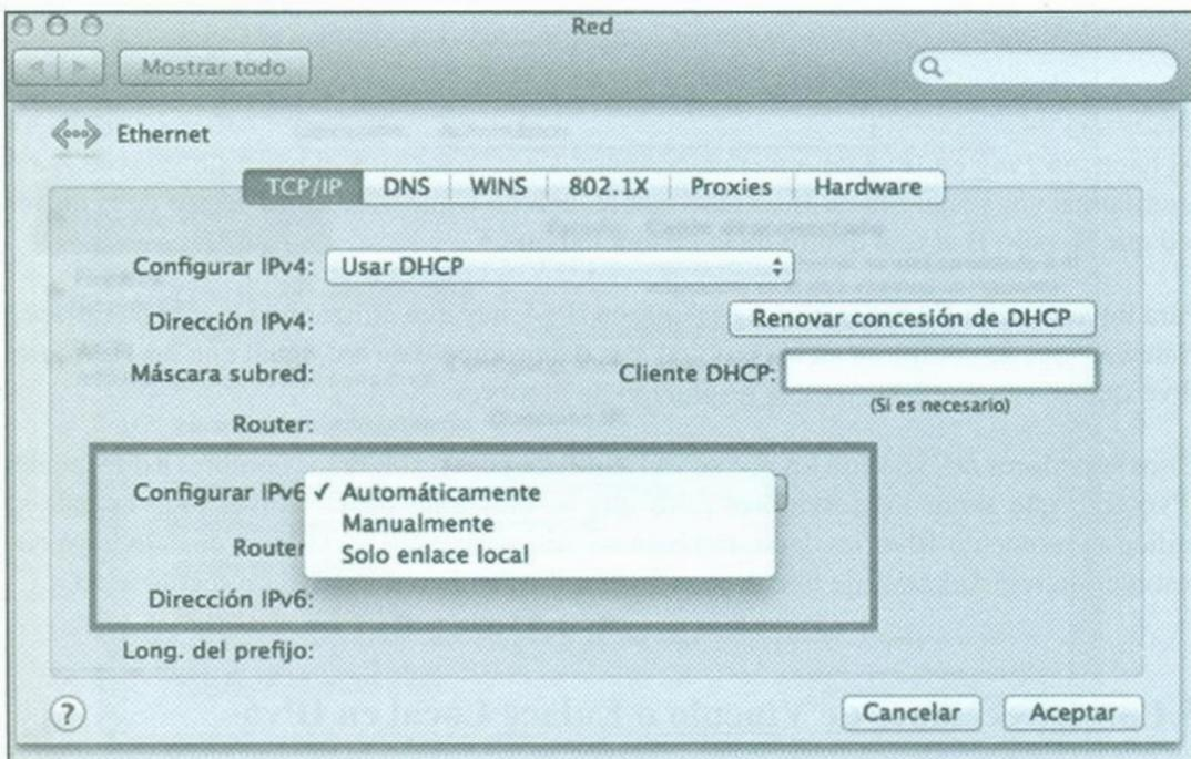
Fig. 5.8.- Configuración por defecto en MAC OS X.
