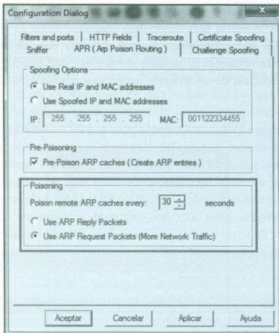
Fig. 4.14.- Configuración de *ARP Request* para el envenenamiento.
