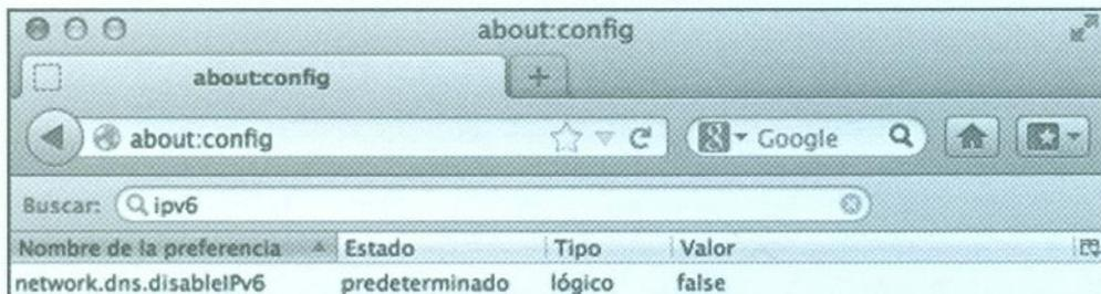
Fig. 5.41.- Configuración por defecto de resolución de registros AAAA en Mozilla Firefox.
