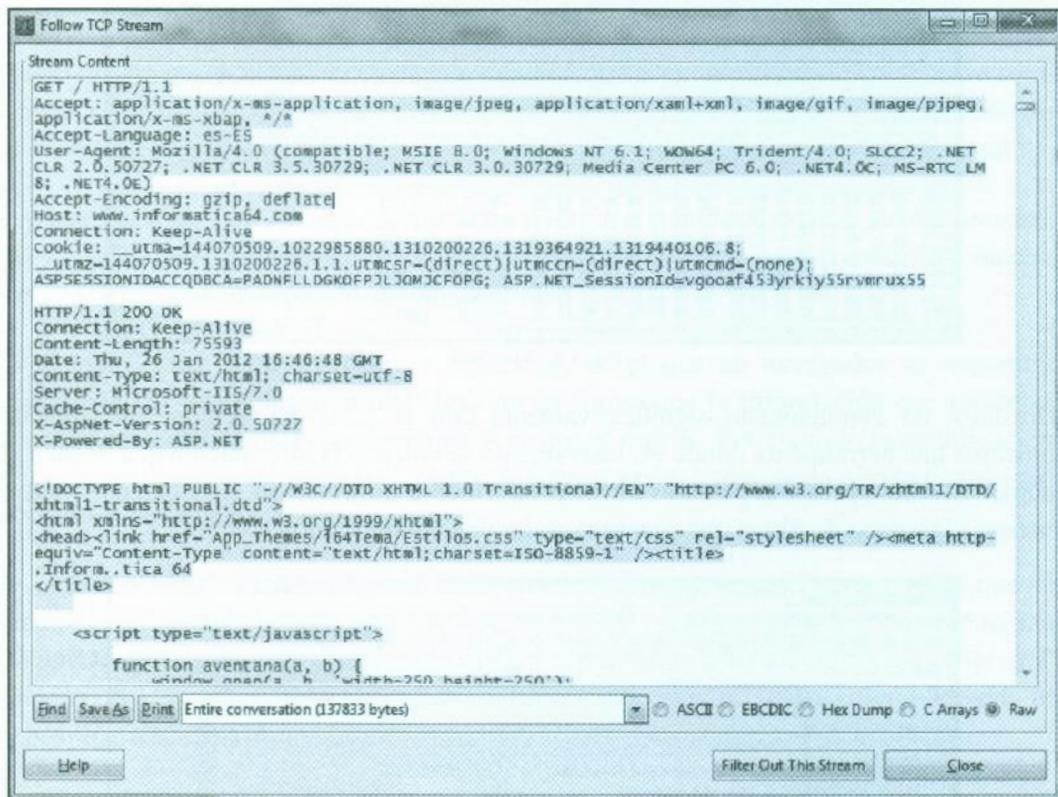
Fig. 3.5.- Reconstrucción de una comunicación con *Wireshark*.
