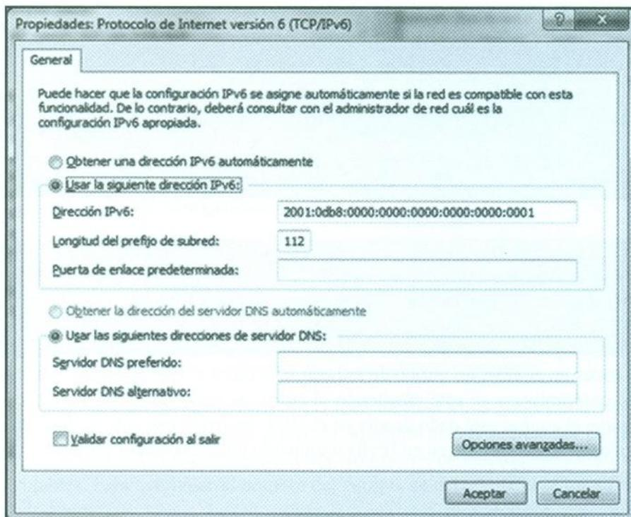
Fig. 5.7.- Ejemplo de configuración de IPv6 en Windows.
