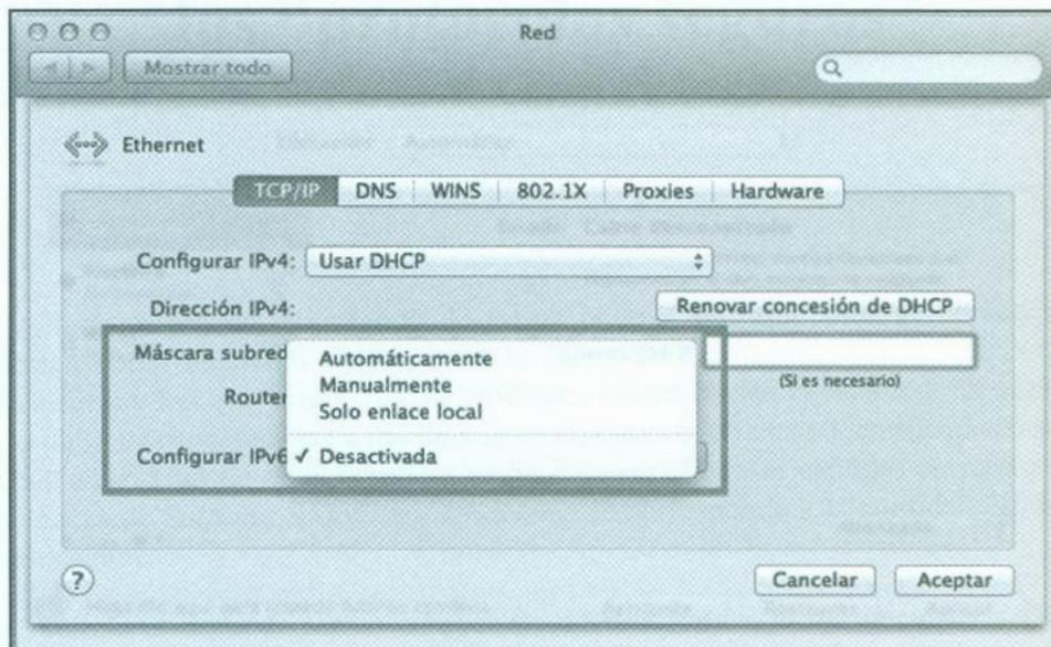
Fig. 5.78.- IPv6 desactivado en la interfaz seleccionada.
