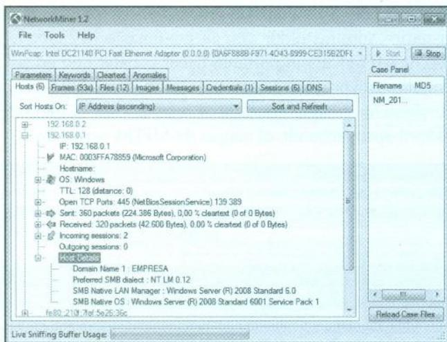
Fig. 4.27.- Información proporcionada por *NetworkMiner* del servidor.
